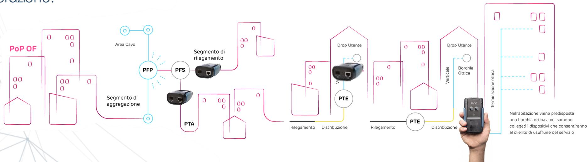
L'EX-1 permette di verificare la potenza ottica ricevuta nel punto di misura per dare il primo check, inoltre permette di emulare l'eventuale ONT del cliente\* ed **interfacciarsi direttamente con l'OLT in qualsiasi punto della rete, bypassando così la necessità di accedere all'unità abitativa** dell'utente e permettendo di effettuare così, tutti i test direttamente sul campo, tramite uno strumento palmare e la sua pratica app.
