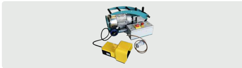
ARGANELLO TIRACAVI ELETTRICO PER TUBETTI INTERRATI E MINICAVI F.O. AEREO (F. 8KN)
